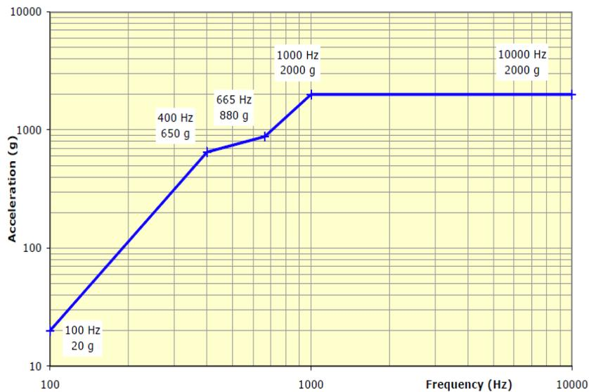
**Hüllkurve des Schockspektrums an einem Anschluss zufolge Trennung Fairing und Oberstufe**
